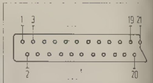
Slika 1: Priključak SCART, pogled na televizor otposadi
